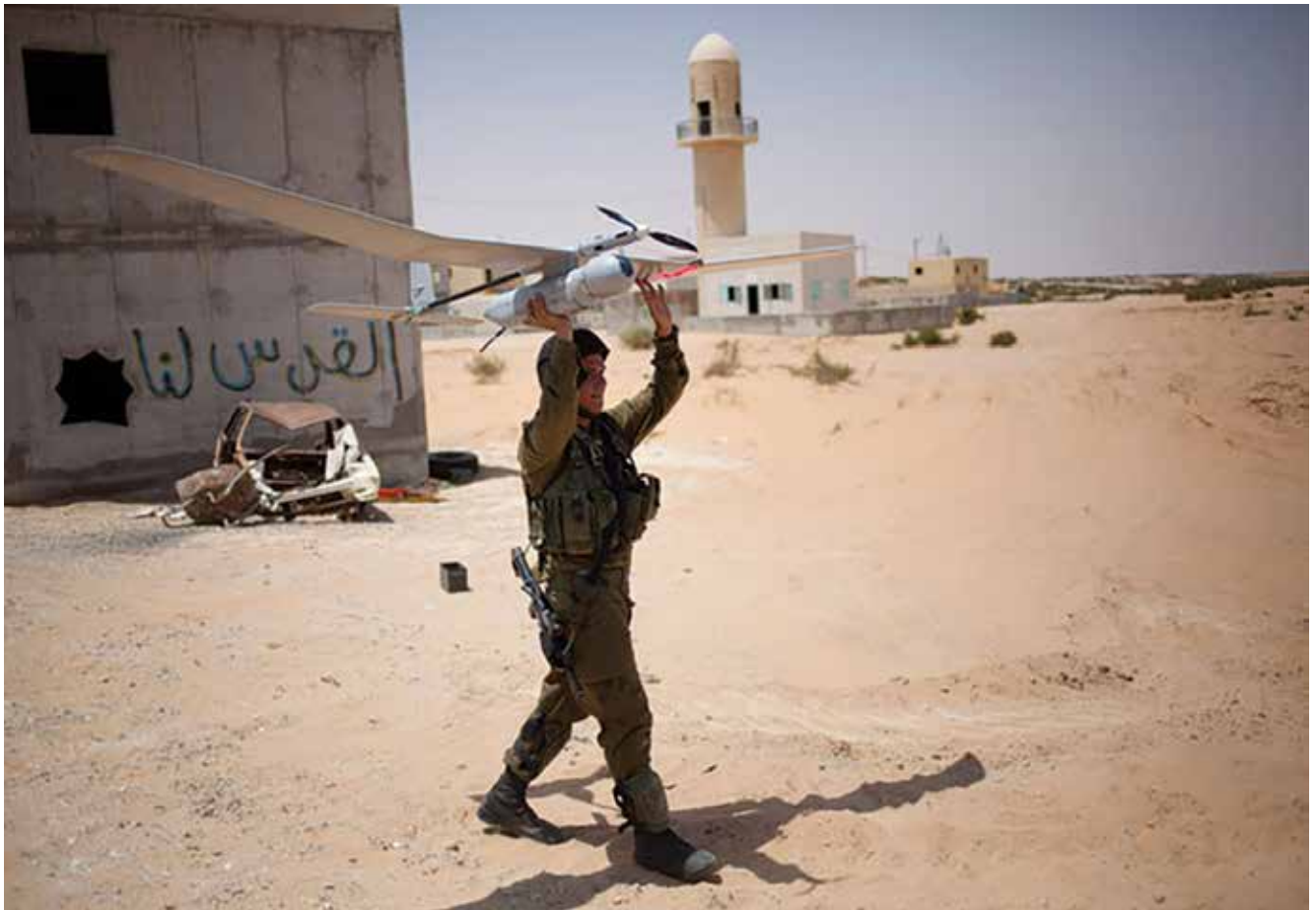
שיגור מזל"ט טקטי מסוג רוכב שמיים לאיסוף מודיעין | ההתקדמות הטכנולוגית המסחררת של העשורים האחרונים יצרה יכולות איסוף המאפשרות למפקד בשדה הקרב המודרני לשפר את שליטתו בסביבתו במהלך ההכנות לקרב ותוך כדי ניהול הקרב ולהשתמש במשאבים העומדים לרשותו באופן מיטבי אל מול תמונת מצב ומשימה נתונות, לקבל החלטות טובות יותר ולהגיע לתוצאה הרצויה
